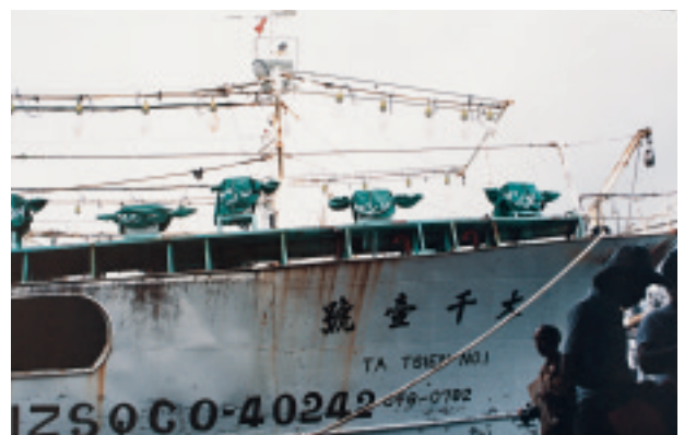
圖4. 魷釣機（帆布覆蓋者）一般配置於漁船兩側
